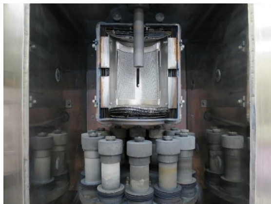
真空炉内の12連治具
