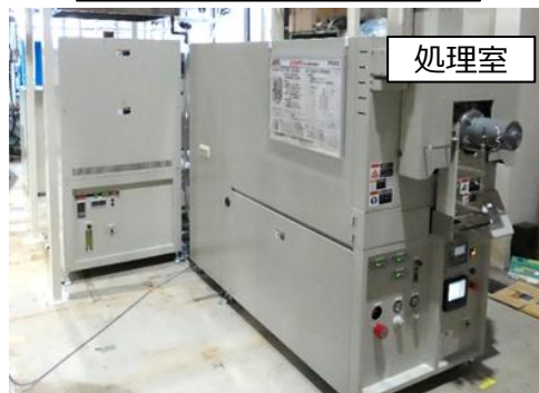
過熱水蒸気処理装置 2
